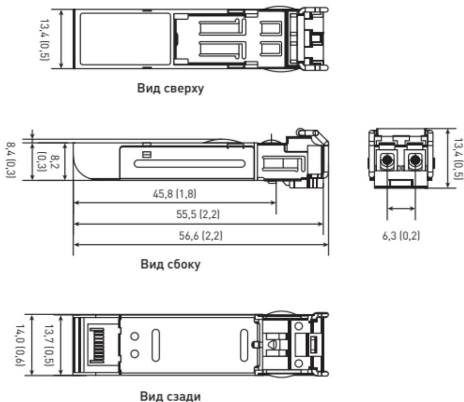
**Рис. 1 — Габаритные размеры TSX-SFP-HM2D-85-03**
