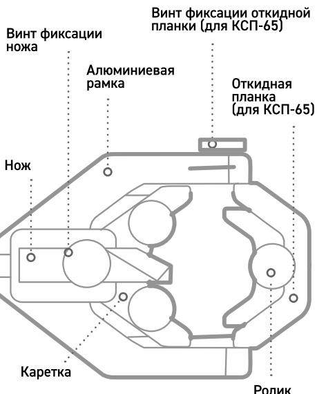
В процессе разделки кабель размещается в рабочей зоне инструмента, нож устанавливается на необходимую глубину разделки. Вращение инструмента по разделяемой поверхности происходит за счет роликов. Инструмент КСП-65 имеет откидную рабочую голову, что позволяет упростить установку на кабеле.
