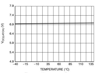
Figure 14.  $V_{CC(LATCH)}$  vs Temperature
