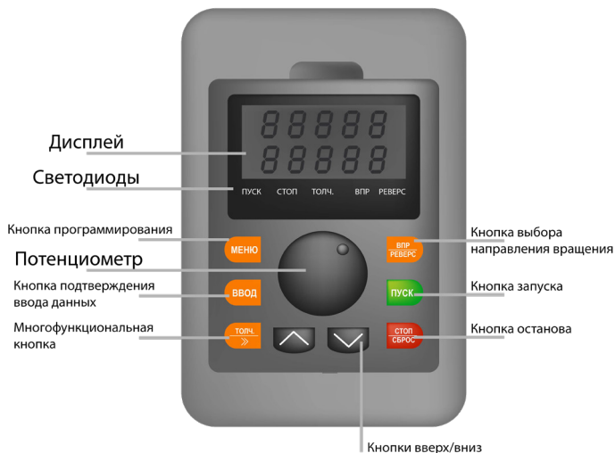
Рис. 5.1.1 Функции кнопок и светодиодов панели управления
